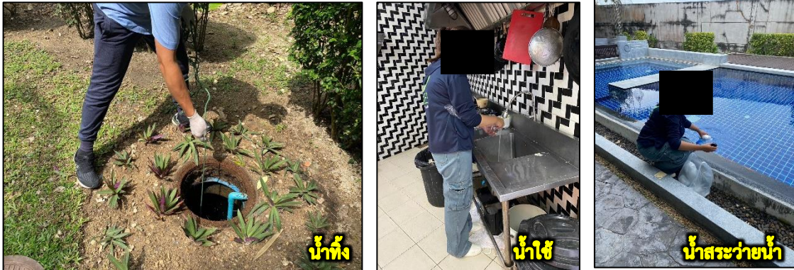
รูปที่ 3-13 เก็บตัวอย่างน้ำทิ้ง น้ำใช้ และน้ำจากสระว่ายน้ำ
