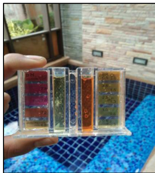
รูปที่ 3-42 การตรวจสอบคลอรีน บริเวณสระว่ายน้ำ ภายในโครงการ
